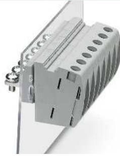
Проходные клеммы, герметизируемые заливкой, горизонтальное подключение провода, внутренняя часть с винтовым зажимом M5
